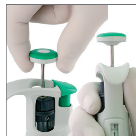
Podwójna nastawa pojemności przyciskiem lub pokrętle
